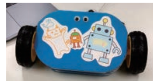
人間のポーズを認識して動く AI ロボット「まーちゃん」
